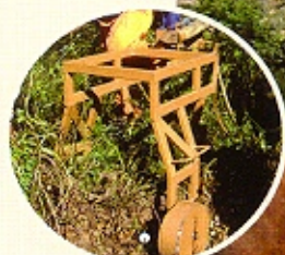
Implemento para cosecha a tracción animal (fabricante CAREYSO S.R.L.)
